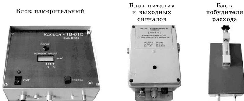
Рис. 6.2. Фотоионизационный газоанализатор КОЛИОН-1В-01С
