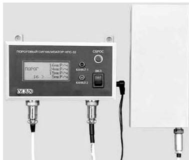
*Рис. 8.11. Сигнализатор НПС-3*
